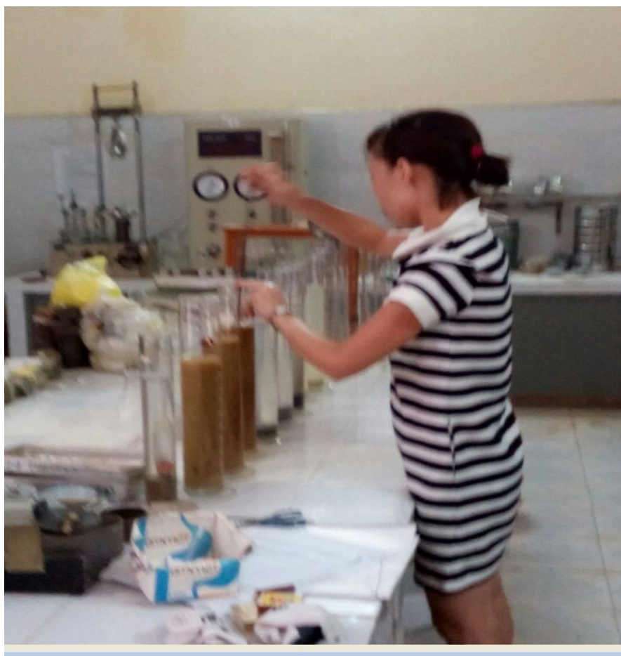
HÌNH 6. HÌNH ẢNH VỀ CÔNG TÁC THÍ NGHIỆM THÀNH PHẦN HẠT
