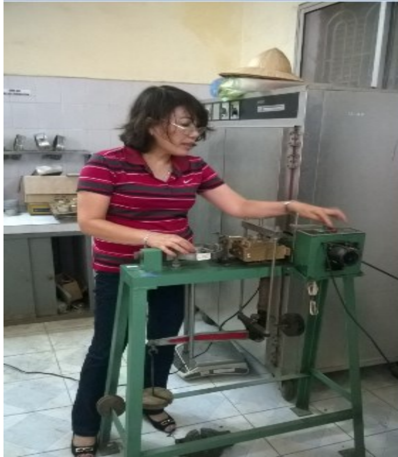
HÌNH 8. HÌNH ẢNH VỀ CÔNG TÁC THÍ NGHIỆM CẮT PHẪNG
