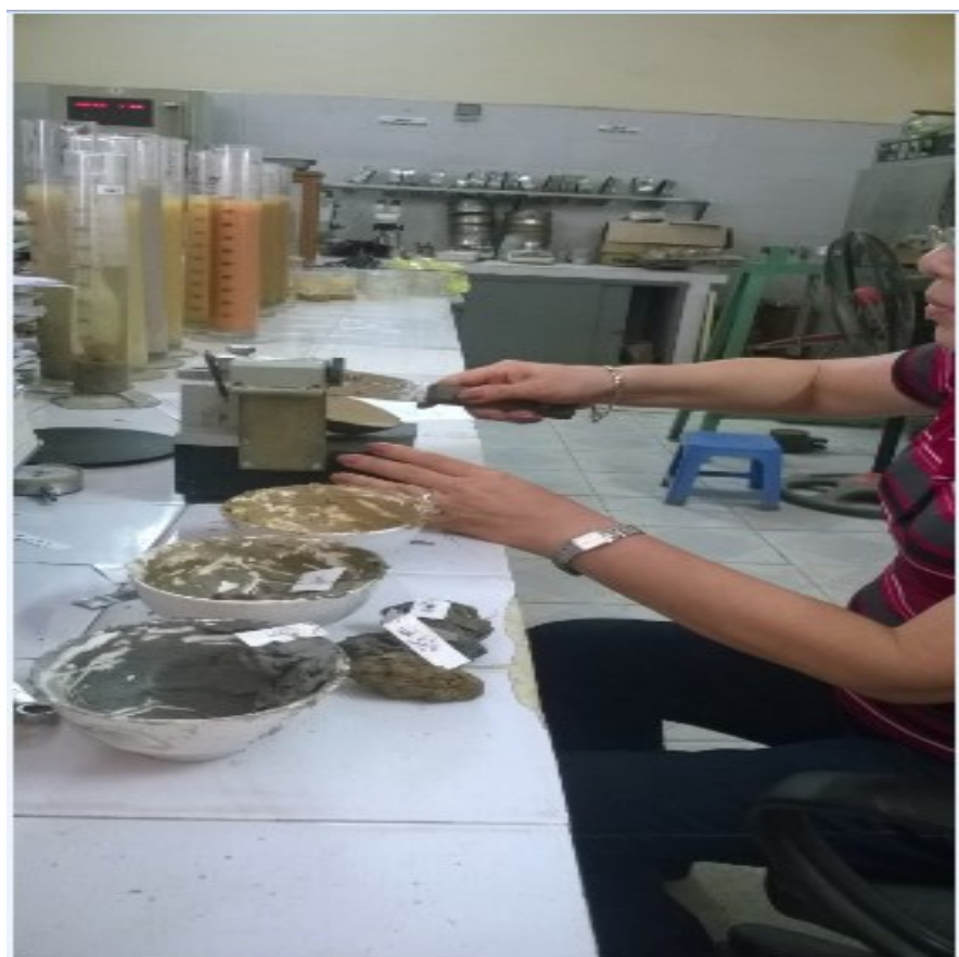
HÌNH 5. HÌNH ẢNH VỀ CÔNG TÁC THÍ NGHIỆM GIỚI HẠN DỄO
