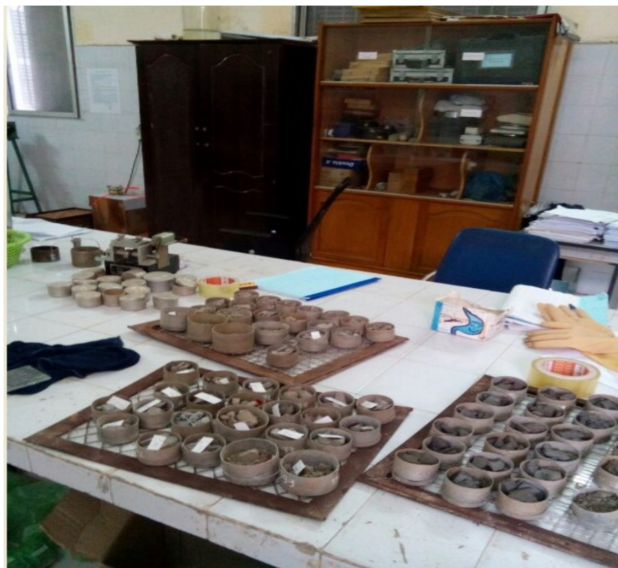
HÌNH 4. HÌNH ẢNH VỀ CÔNG TÁC THÍ NGHIỆM ĐỘ ẨM
